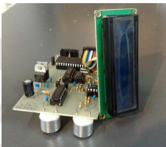
شکل ۹: مدار اندازه‌گیری فاصله با حسگر فراصوت
